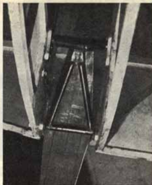
Uudenaikaisen jousiteräslaskutelineen kiinnitys.
