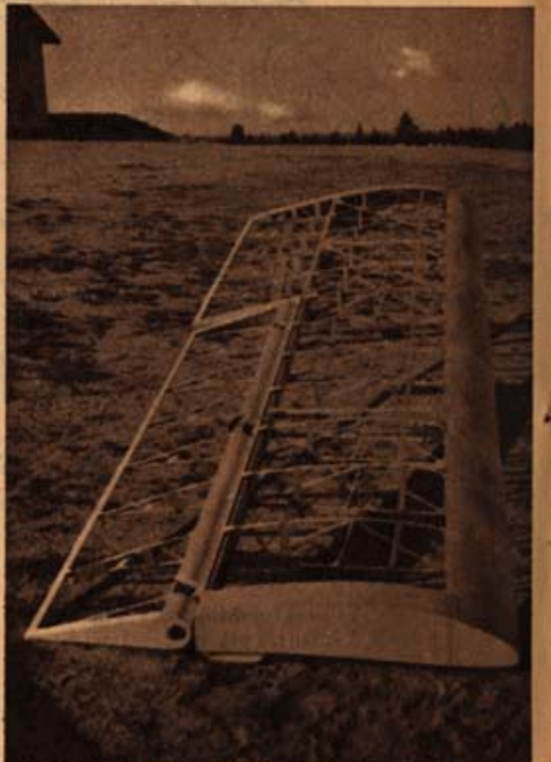
Harakka II:n siipi on huomattavasti alkuperäistä yksinkertaisempi ja lujempi.
